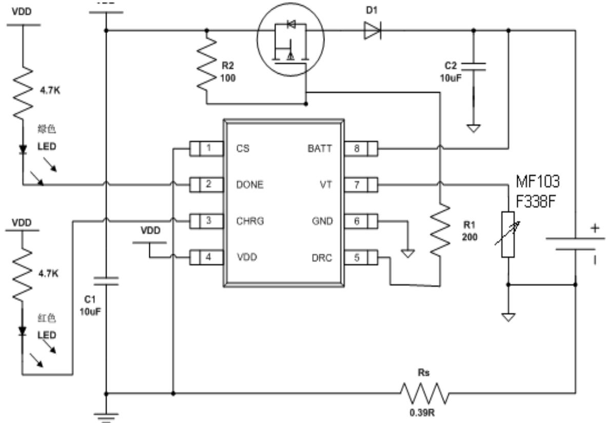
注：D1 为肖特基；RS 建议采用高精度（1%）以保证电流精度，R1 和 R2 没有精度要求；
