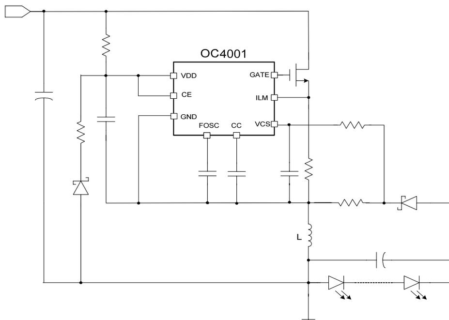
图 1 OC4001 高精度升降压恒流驱动应用
